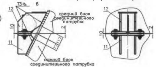
Узлы стыковки блоков соединительных патрубков В (1:10) (12 мест)
